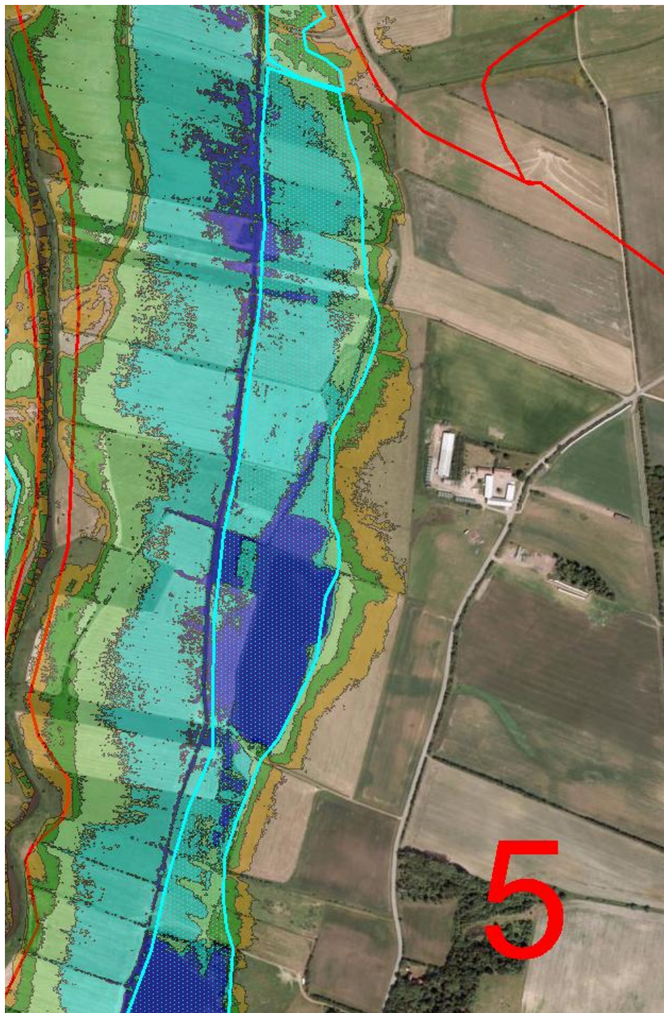
Figur 033. Infiltrationsarealet for den nordlige del af delområde 5. Arealet af hele infiltrationsområdet ved delopland 5 er 31 hektar (opland 364 hektar), og den resulterende kvælstoffjernelse er 125 kg N/ha/år, svarende til en reduktion på 80 %.
