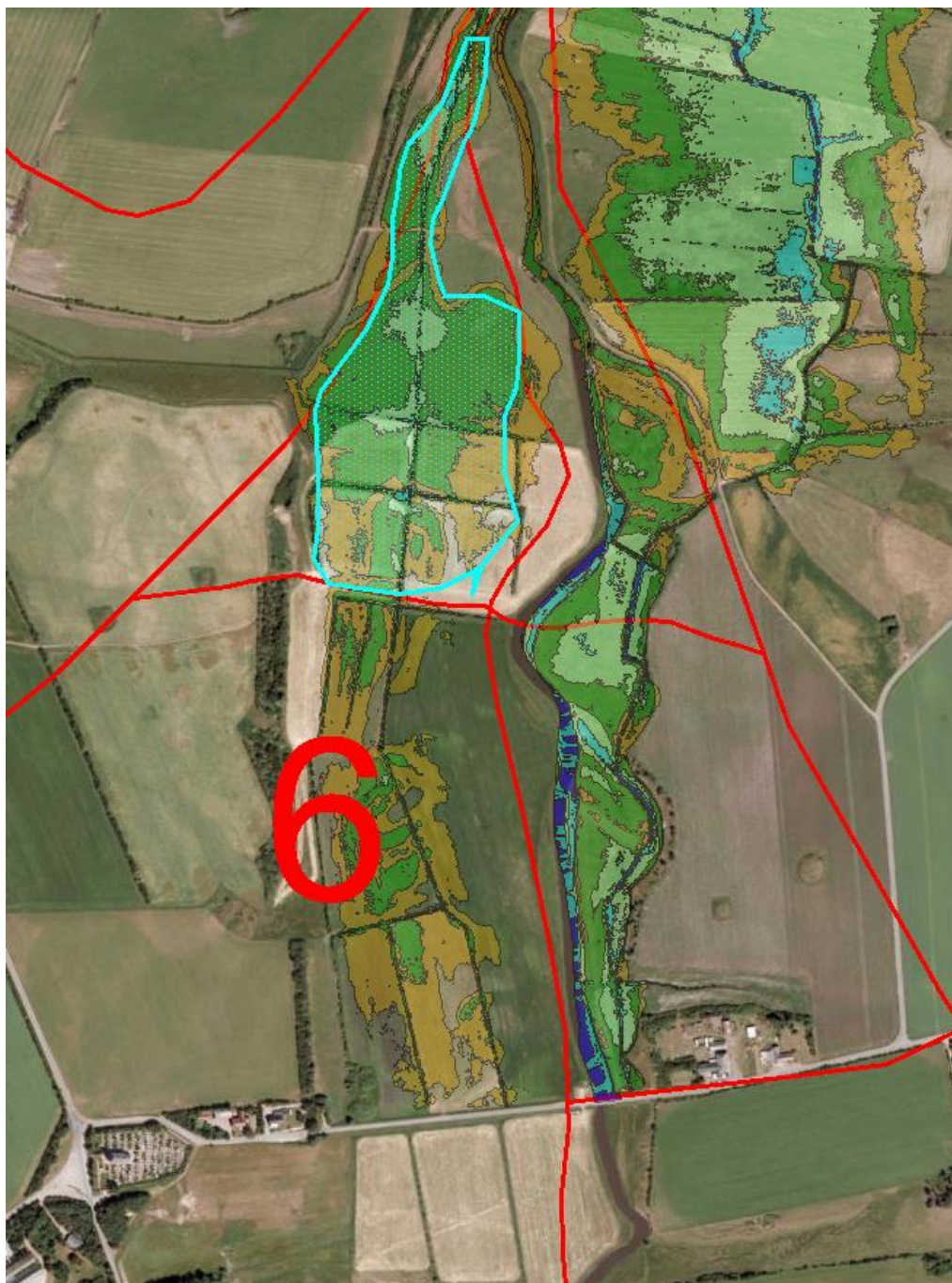
Figur 35. Infiltrationsområdet for delopland 6. Arealet af infiltrationsområdet er 7,2 hektar (opland 119 hektar), og den resulterende kvælstoffjernelse er 216 kg N/ha/år, svarende til en reduktion på 60 %.
