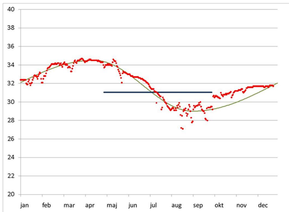
Figur 21. Beregnede Manningtal for Karup Å baseret på 2008 opmålingen samt vandførings- og vandstandsdata fra 2008. Den sorte streg viser gennemsnit for sommerperioden maj - september.
